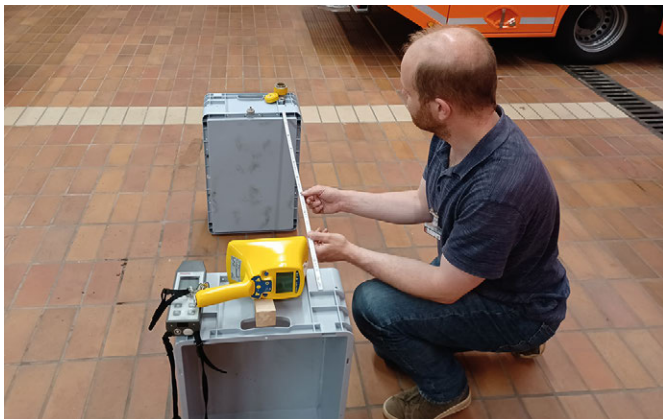
Messungen zum Ansprechverhalten von Strahlenschutzmessgeräten für die Norm DIN 25700. (Foto: Oliver Meisenberg)
